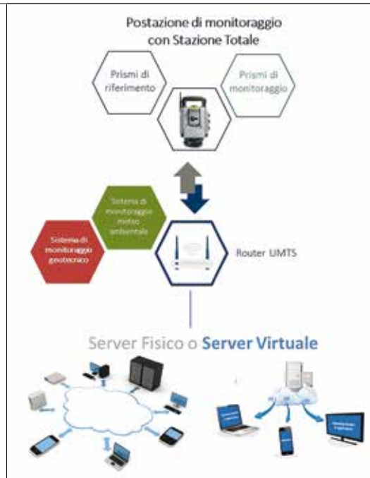
3. La riproduzione hardware e software del sistema di monitoraggio utilizzato sul ponte San Michele
