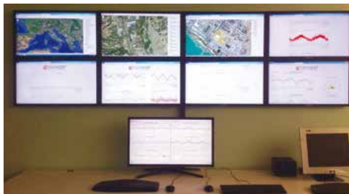
5. La postazione per il controllo del monitoraggio con dashboard, soglie e allarmistica
