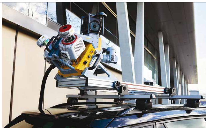
2. Il sistema Mobile Mapping 3D Trimble MX9
