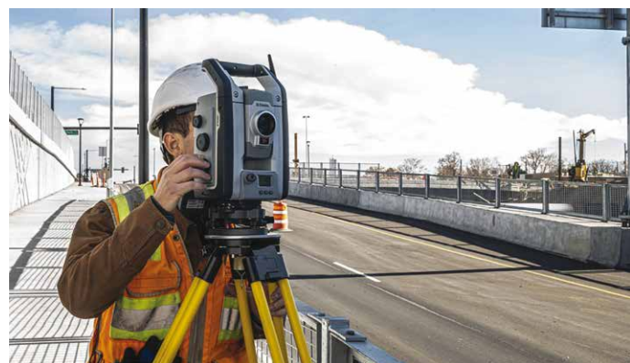
1. La stazione totale automatica Trimble S7
