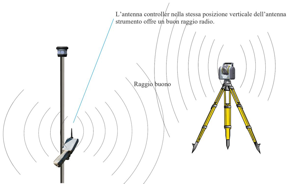
**Figura 4.8** Raggio radio buono e l'antenna controller è nella stessa posizione verticale dell'antenna strumento
