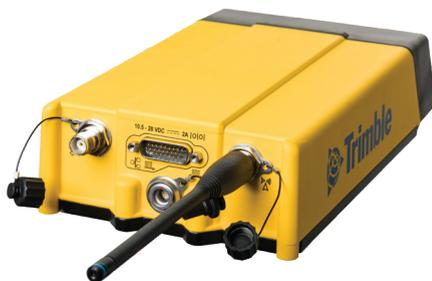
**NOTA** – Se si utilizza un cavo antenna esterna UHF a 450 MHz a polarità standard, è necessario un adattatore TNC a polarità inversa (P/N 119128). Non utilizzare un adattatore con antenna stilo a polarità standard (p.e. P/N 44085-60) dato che potrebbe influenzare negativamente le prestazioni della radio.
